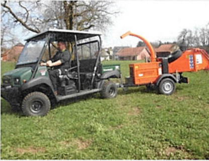
Kawasaki Mule 4010 DT mit aufgeklappter hinterer Sitzbank samt angehängtem Timberwolf-Hacker.
